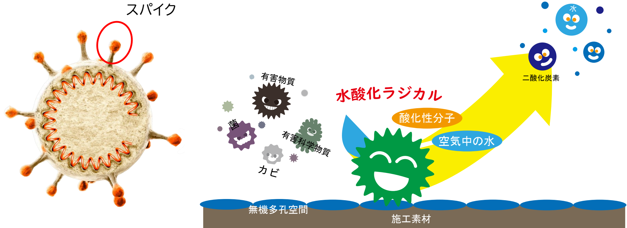
オールチタンコーティング分解原理イメージ
